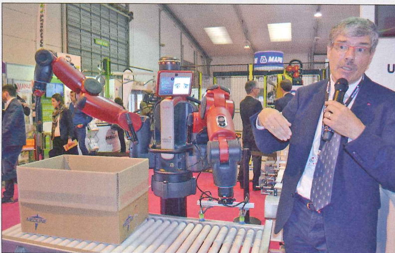
◀ Lab-Sticc (Université de Bretagne sud, 56) a présenté un robot collaboratif ou « corobot », équipé de deux bras et de sept axes.
